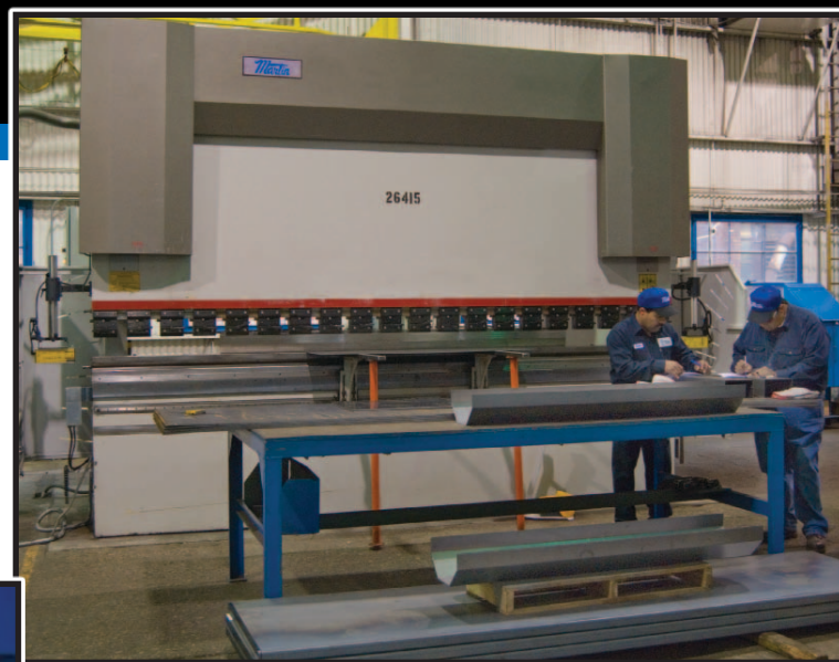
右：数控压力制动器用于生产马丁传送类产品。
